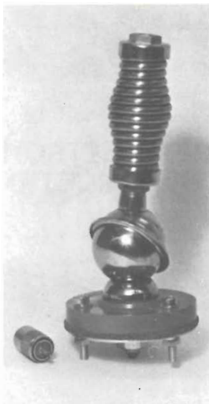
Spesso i CB cambiano alcune parti della stazione: un rosmetro per controllare le stazionarie può divenire quasi indispensabile. Nell'immagine un basamento ad alta resistenza per la barra M.
