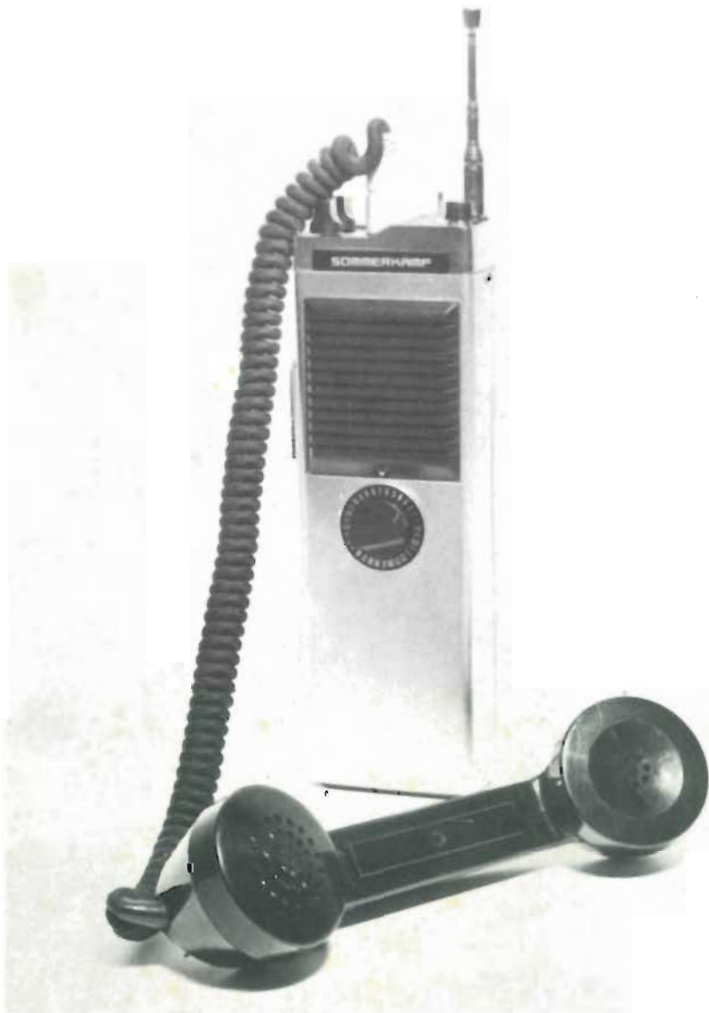
Il collegamento fra apparecchio e microtelefono si realizza mediante una connessione DIN. In basso, particolare del circuito.
