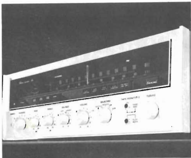
In alto, il sintonizzatore Sansui SIX: tutti i punti di comando sono raccolti sul pannello frontale dell'apparecchio. Sotto, il modello Audio 400 della Braun. Il modulo di sintonia di cui è equipaggiato quest'apparato presenta una sensibilità di 1µV.
