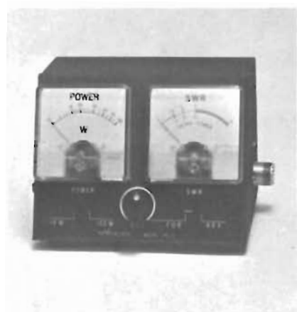
Il misuratore di onde stazionarie, molte volte accompagnato con un wattmetro per radiofrequenza, è uno degli strumenti che possiamo definire indispensabili per trarre il massimo rendimento dalla propria stazione. Nell'immagine il modello prodotto dalla Hansen.
