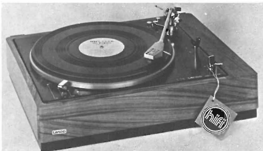
La meccanica della piastra di riproduzione Lenco L78 si avvale di pregevoli soluzioni tecniche. Per quanto riguarda la testina l'apparecchio è corredato di una cartuccia Lenco M94.
